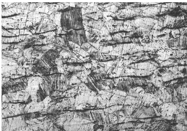
Рисунок 59 - Структура стали 08X18H10Т после РКУП и нагрева на 550°С, \tau=20 ч. (световая микроскопия)
